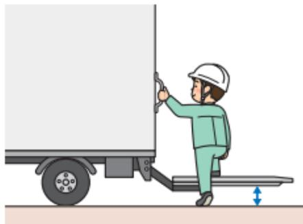
テールゲートリフターを昇降設備として使用する場合は、中間位置で停止させてステップとして使用してください。
